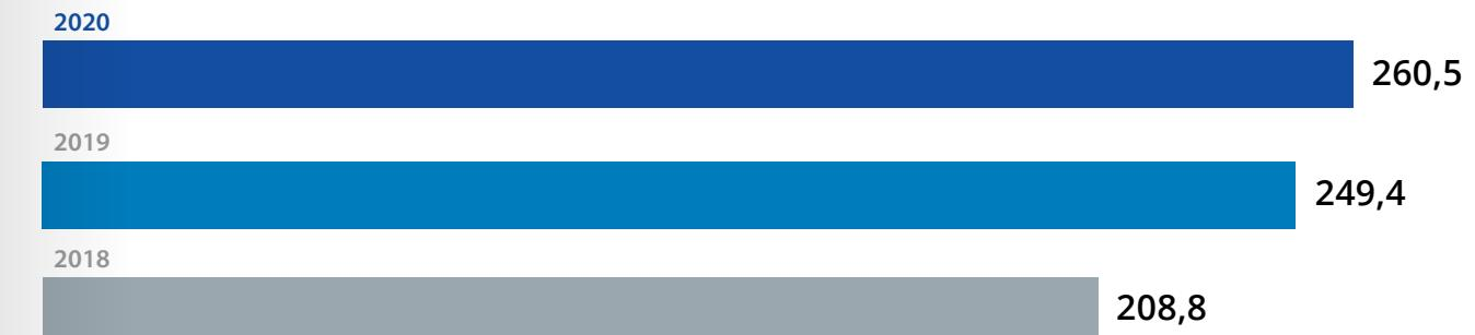
Повышение потребления газа на собственные нужды в 2020 году обусловлено падением пластового давления и увеличением на ДКС объемов топливного газа на компримирование.
