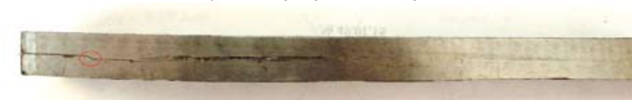
Фото 6. Вздутия, микротрещины на внутренней поверхности образца О3
