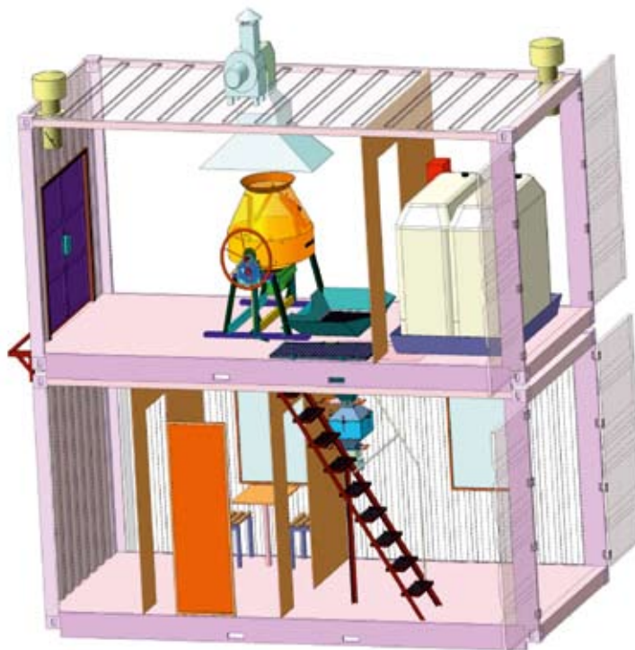
Рис. 2. Передвижная смесительная установка ПСУ. Компоновка технологических модулей для изготовления ВВ с встроенным топливным модулем
