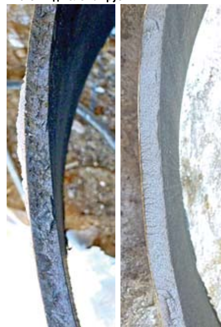
Рис. 3. Вид излома трубы
