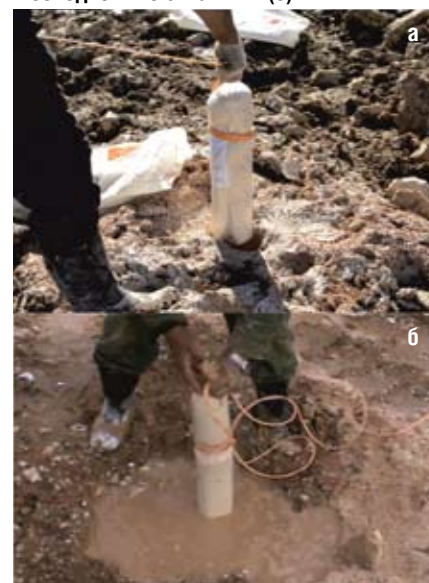
Рис. 1. Промежуточный детонатор (боевик) из порошкообразного ВВ в полимерной оболочке. Установка боевика в сухие (а) и обводненные скважины (б)
