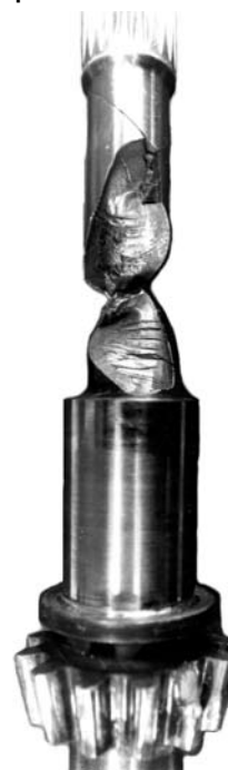
Рис. 1. Фотография разрушенного вала-шестерни
