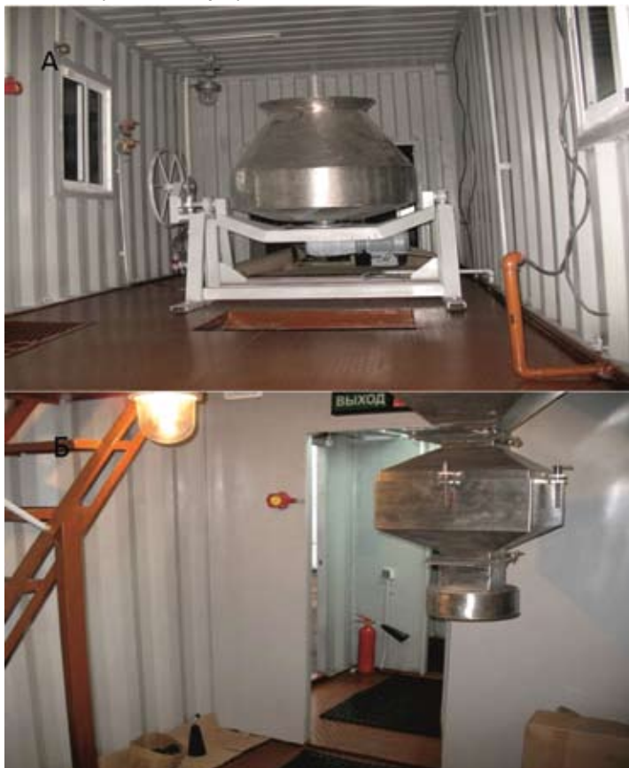
Рис. 3. Технологические модули передвижной смесительной установки ПСУ: А – смесительное отделение (верхний модуль); Б – приемное отделение (нижний модуль)
