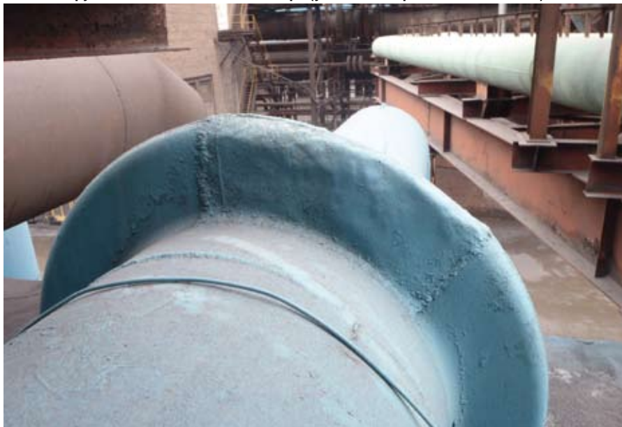
Рис. 2. Разрушение сварного шва линзового компенсатора на аспирационном коллекторе
