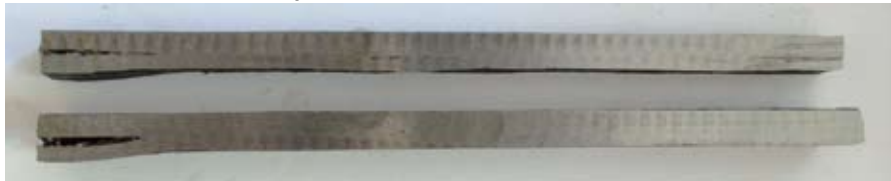
Фото 5. Расслоение стенки, ступенчатое растрескивание образца О2
