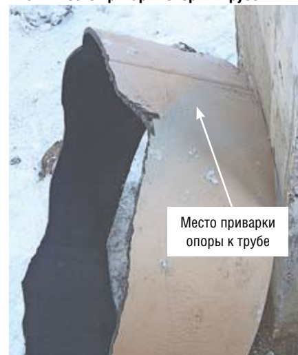
Рис. 3. Вид излома трубы
