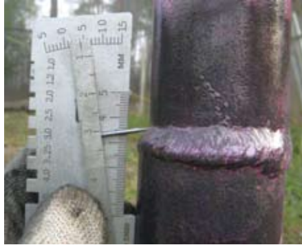
Рис. 3. Недопустимое смещение кромок сварного соединения
