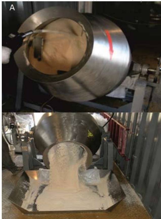
Рис. 4. Технологические процессы производства промышленного взрывчатого вещества в смесителе СВВ: А – дозированная подача жидкого горючего компонента; Б – выгрузка готового продукта
