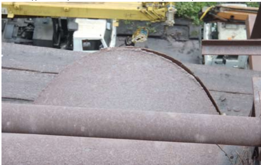
Рис. 2. Разрушение сварного шва линзового компенсатора на аспирационном коллекторе
